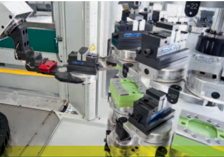
Automatisierte Bestückung der Fräszentren mit Hilfe von Einlegeroboter und Palettiersystem
