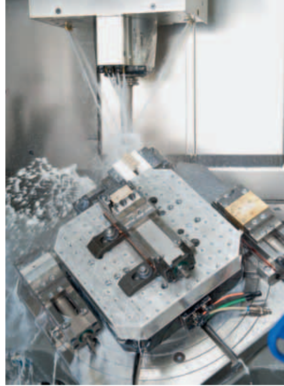
Fräsbearbeitung mit gleichzeitiger Ansteuerung von 5 Achsen
