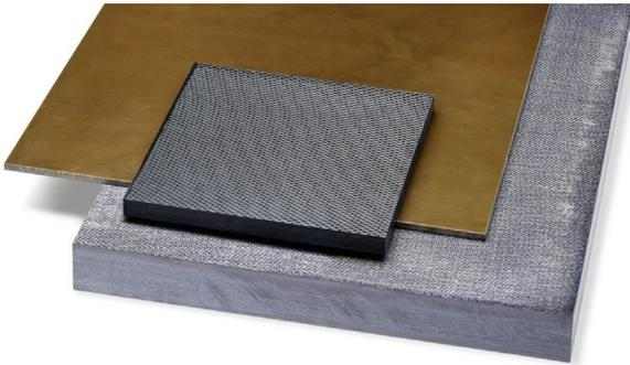
Thermoplastische Verbundwerkstoffe sind prädestiniert für Leichtbau-Anwendungen mit hohen Anforderungen an Formgebung und Material.
