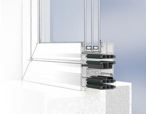
Fensterschnitt: Die glasfaserverstärkten „insulbar“ Dämmstege verbinden die Innen- und Außenschalen der Metallrahmenprofile.
