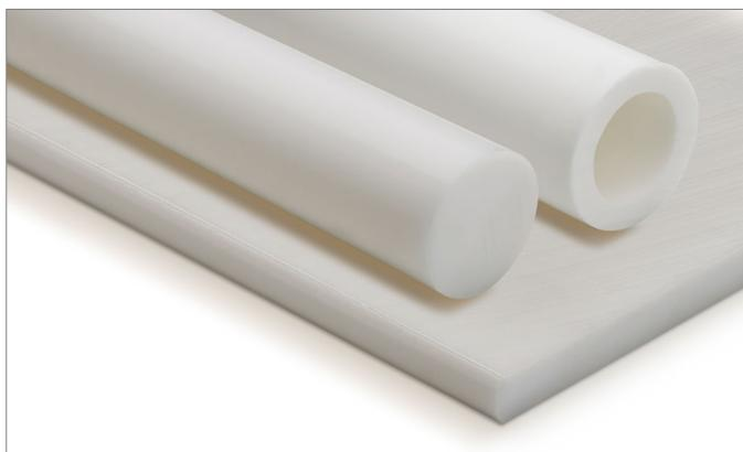
TECAFORM AH RP: Die Platten, Rundstäbe und Hohlstäbe werden aus wiederaufbereiteten Sekundärrohstoffen extrudiert.
