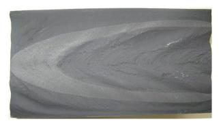
これは、投入する樹脂の色を少しだけ変えて押出成形機に時間差で投入し、押出成形した丸棒の押出方向の断面の写真を撮ったものです。
