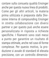
nale costante che consente di ottenere filamenti con tolleranze di diametro di ±0.05 mm. Viene inoltre garantito un attento controllo dell'umidità grazie a operazioni di essiccazione dei materiali e successivo confezionamento ermetico con materiale assorbente e barriera in film composito rivestito di alluminio.
