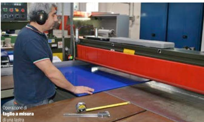
Operazione di taglio a misura di una lastra
