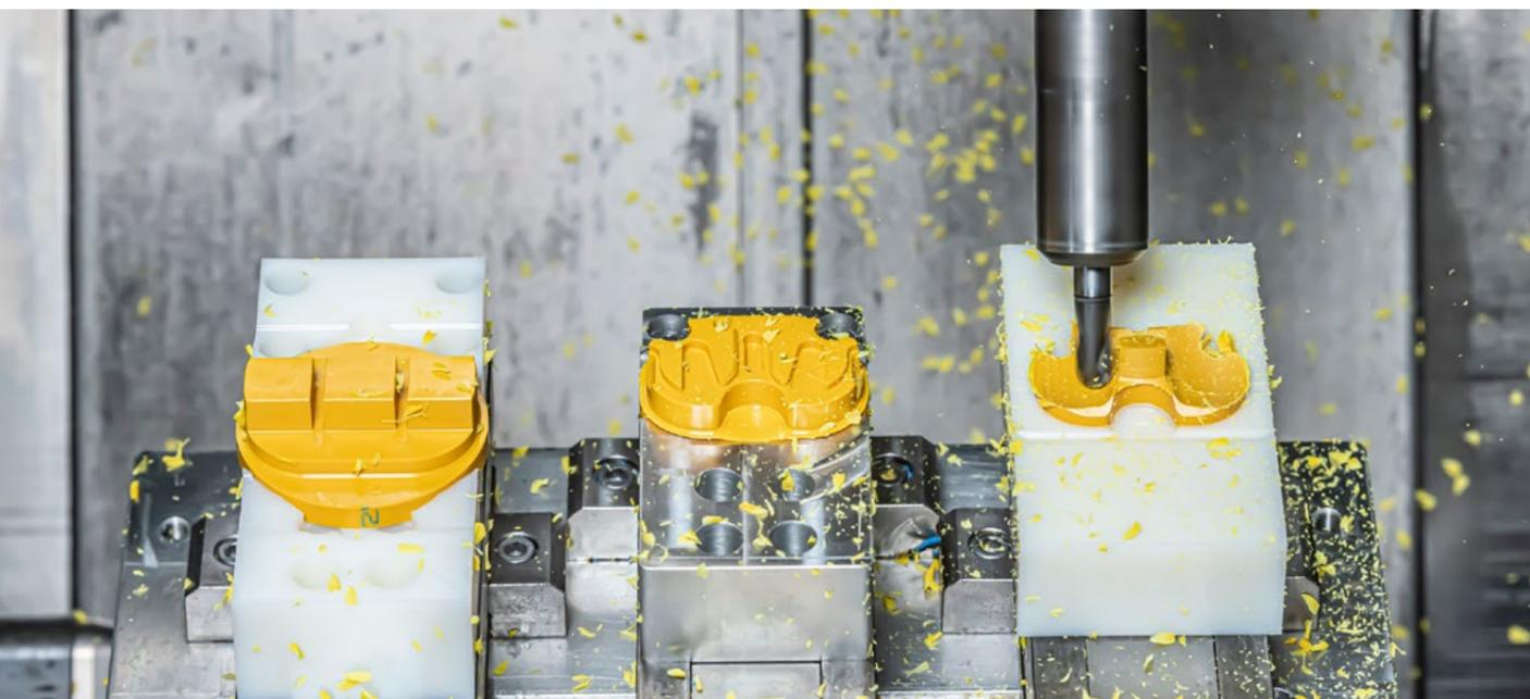
Testimplantate für Kniegelenke: Zerspanung auf einem Bearbeitungszentrum in Cham.
