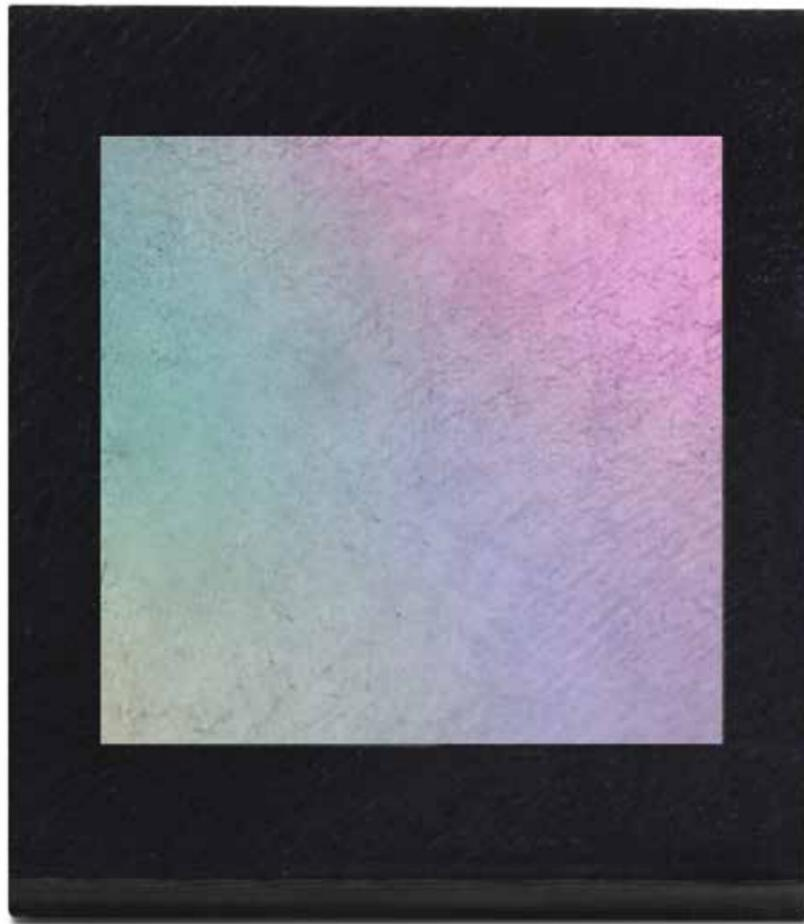
Die Abbildung zeigt Mikrostrukturen (Bragg-Gitter) auf einem Sensor. Das von Ensinger hergestellte Compound TECACOMP PEEK LDS black 1047045 ist extrem temperaturresistent, verfügt über eine sehr gute Bindehaftfestigkeit, eine gute Haftfestigkeit und zeigt eine hohe chemische Beständigkeit gegen Lösungsmittel. Darüber hinaus weist der Werkstoff einen sehr geringen thermischen Längenausdehnungskoeffizienten auf. Foto: Ensinger / IMPT
