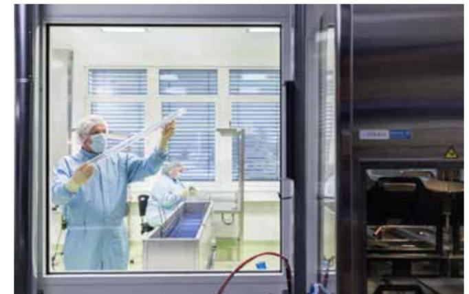
Bearbeitete Teile gelangen durch eine Reinigungsschleuse (rechts) in den Reinraum, wo sie montiert und verpackt werden. Große Teile wie die hier gezeigte Komponente für einen Bioreaktor werden in einem Ultraschallbecken mit hochreinem Osmose-Wasser gereinigt.
