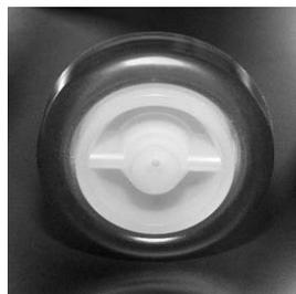
Polyurethan-Teil mit zwei Komponenten, einem härteren PUR-Kern sowie einer weichen PUR-Membran, die miteinander vergossen wurden und deshalb chemisch verbunden sind
