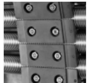
Für die Halteklammern von Stromspulen zur Magnetfelderzeugung wurde das temperaturbeständige und vakuumtaugliche SINTIMID PUR HAT von ENSINGER verwendet.
