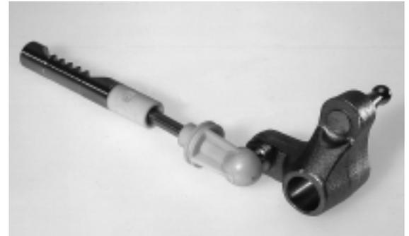
Zahnstange von LuK: Die beiden Kugelgelenke aus TECAMID GF25 TF10mod. wurden von ENSINGER mittels der Zweikomponententechnologie in einem Fertigungszyklus direkt an die Bauteile angespritzt.
